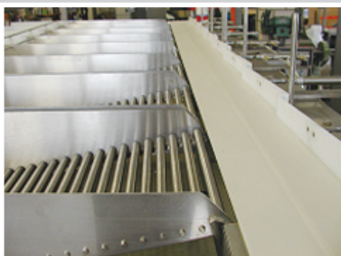
Angesetzte Rollbahnen fangen die zu sortierten Produkte auf und lassen sie auf Stau laufen. Sehr produktschonendes Handling. Abnahme direkt am Packplatz.
