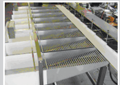
Gesamtanlage UES-8 mit Freilauf-Rollbahnen und angesetzten Sammelbehältern
