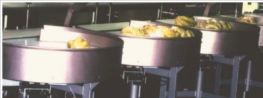
Mit Hilfe von angesetzten Drehtischen am Sortierteil werden Druckstellen bei empfindlichen Lebensmitteln, wie z.B. Bananen, verhindert.
